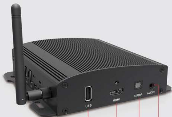
USB HDMI Выход S/PDIF Выход стерео аудио
